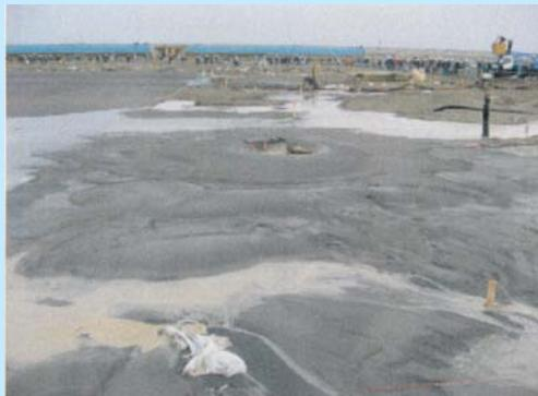
写真3 発破後のアスファルト舗装(未改良部)脇およびマンホール周辺に生じた噴砂
