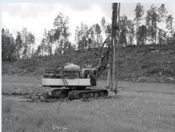
図-2 フィンランドの深層混合処理工機械(粉体系)
