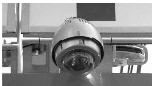
写真－14. 曳航用監視カメラ×1台
