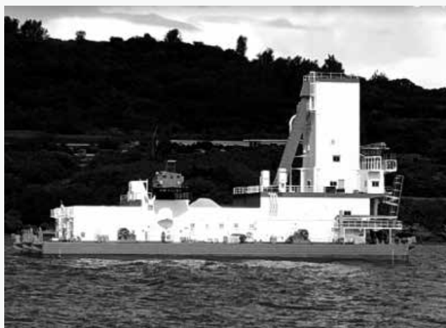
コンクリートミキサー船「久護850」
