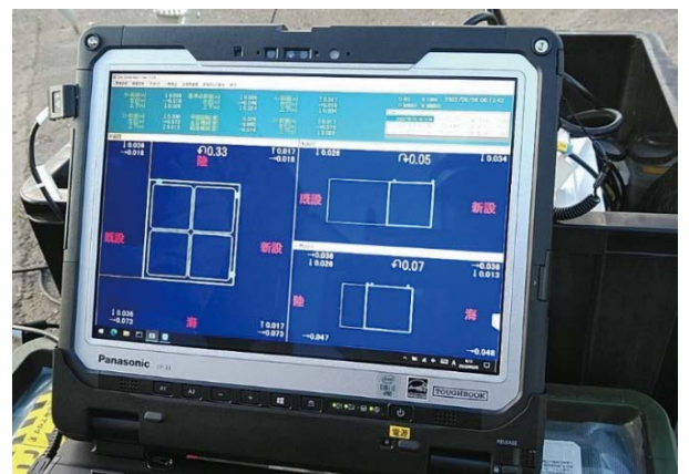
写真-8 モニターによるケーソン位置確認
