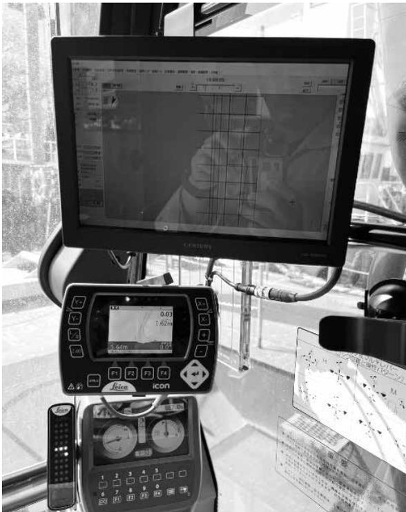
写真-3 マシンガイダンスシステム
