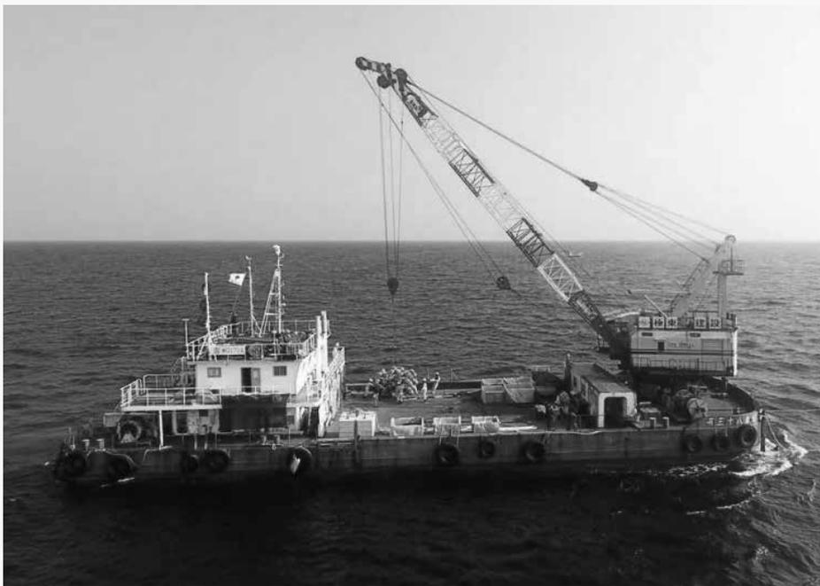
起重機船(100t吊)極東83号(285t) :L=42.0m×B=15.0m×T=3.2m
