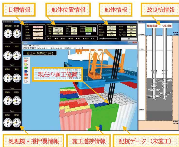
図-7 3D施工システム管理画面例
