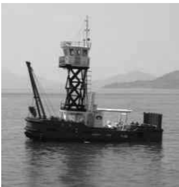
【写真5】 昇降式操舵室
