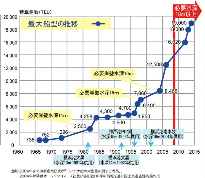
図2 コンテナ船の最大船型の推移
