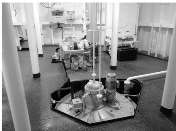
写真-2 可変方向型ポンプジェット式スラスタ
