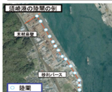
岸壁の前面の胸壁約700mの区間に陸閘が14基設置されている
