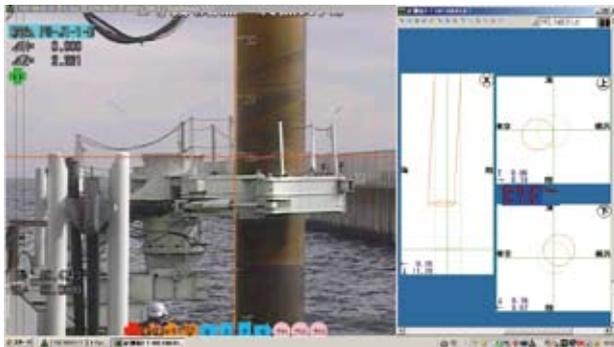
鋼管杭打設モニター画面(写真-4)
